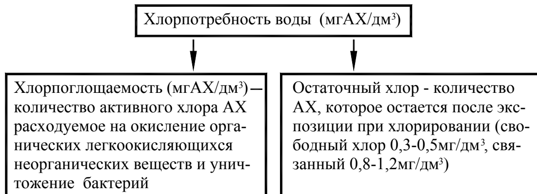
Рисунок 2 – Хлорпотребность воды при окислении хлорсодержащими соединениями
