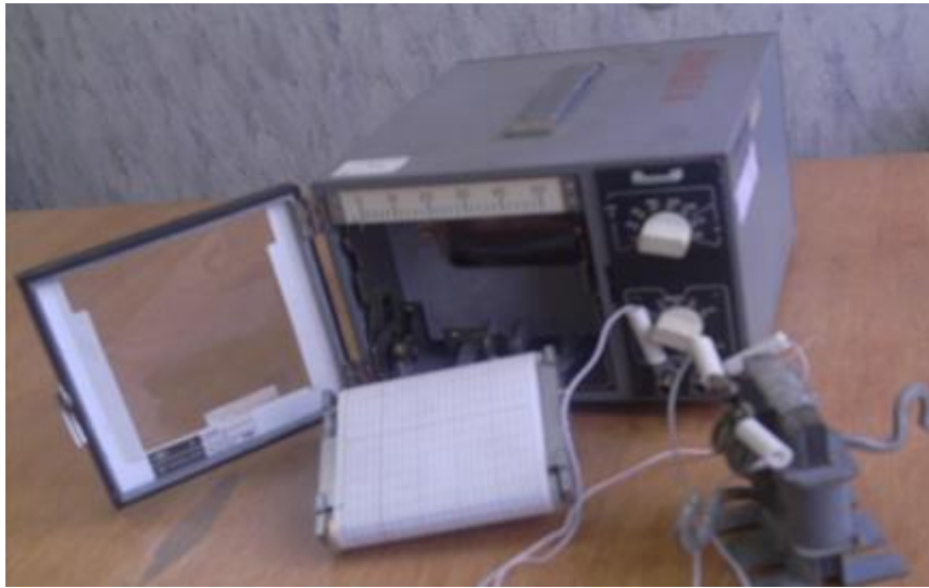
Рисунок 5.14 — Ампервольтметр Н 339 с трансформатором тока
