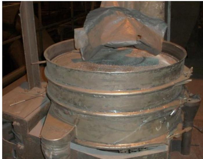
Рисунок 1.4 — Грохота технологического отсева дробы (ротасив)
