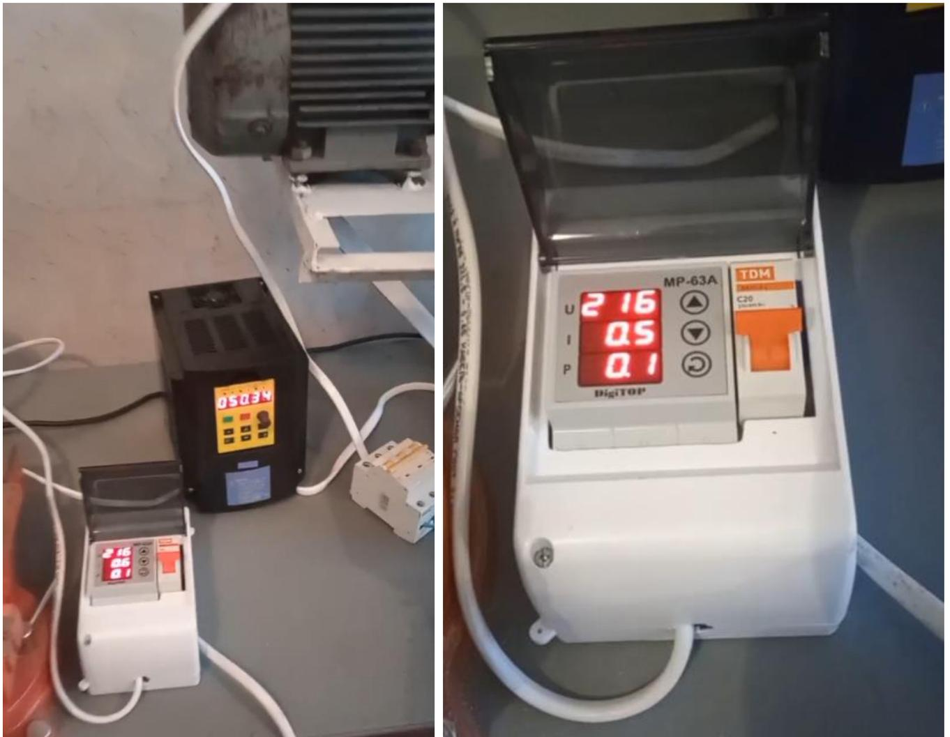
Рисунок 2.11 — Значение мощности холостого хода роторно-ударного измельчителя
