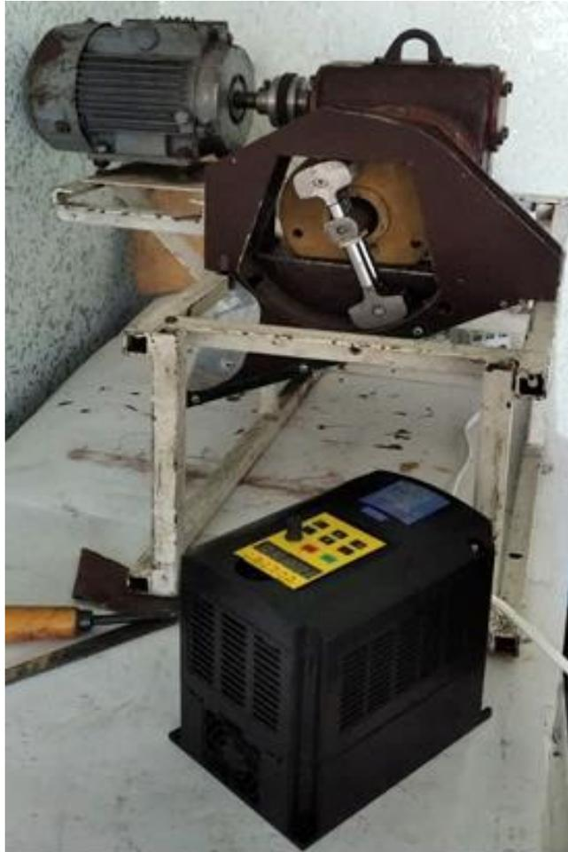
Рисунок 2.9 — Лабораторная установка для проведения экспериментальных исследований роторно-ударного измельчителя
