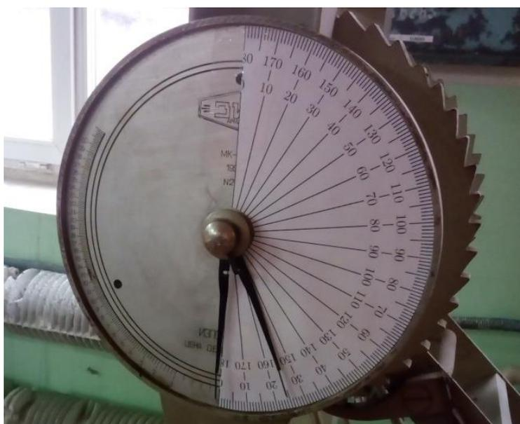
Рисунок 2.5 — Отсчетное устройство маятникового копра со шкалой, учитывающей угол отклонения маятника и энергию удара
