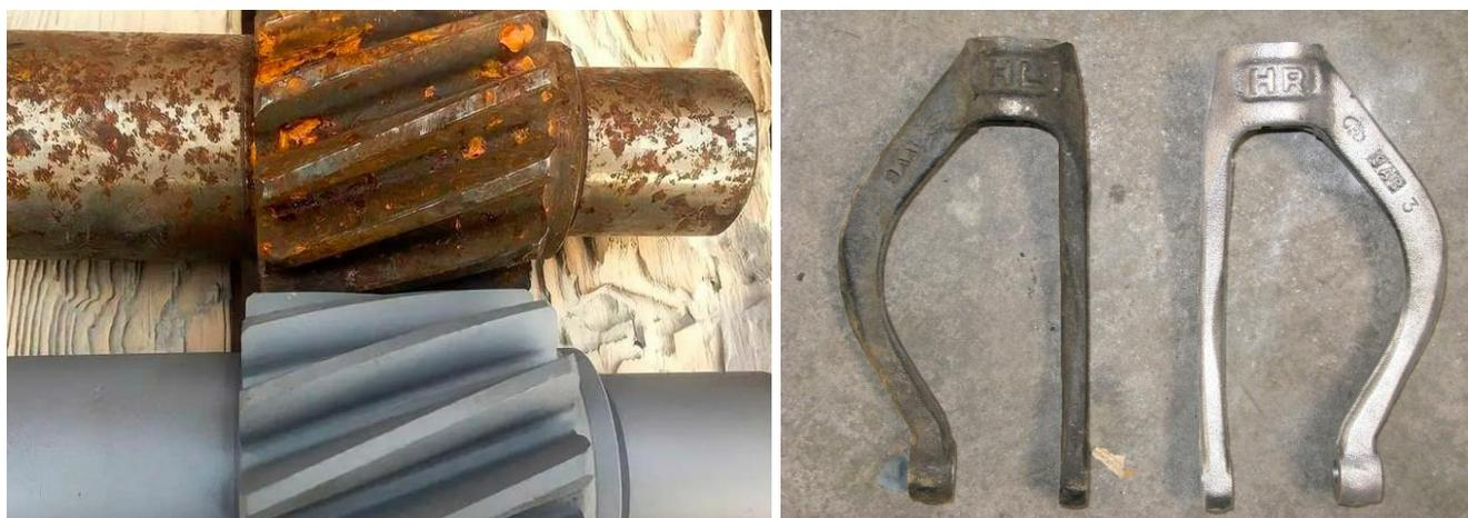
Рисунок 1.1 — Примеры качества поверхности изделий до и после дробеструйной обработки
