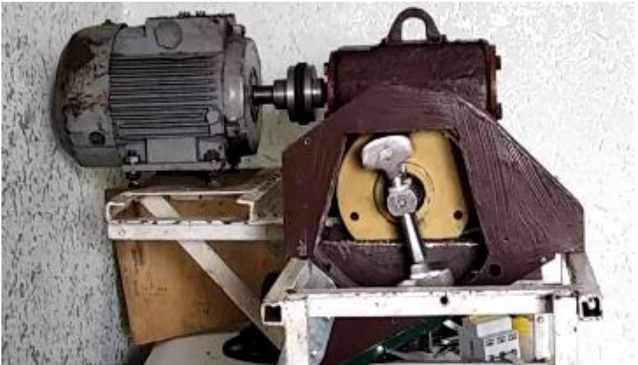
Рисунок 2.8 — Физическая модель роторно-ударного измельчителя
