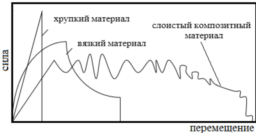
Рисунок 1.8 — Диаграммы ударного разрушения материалов
