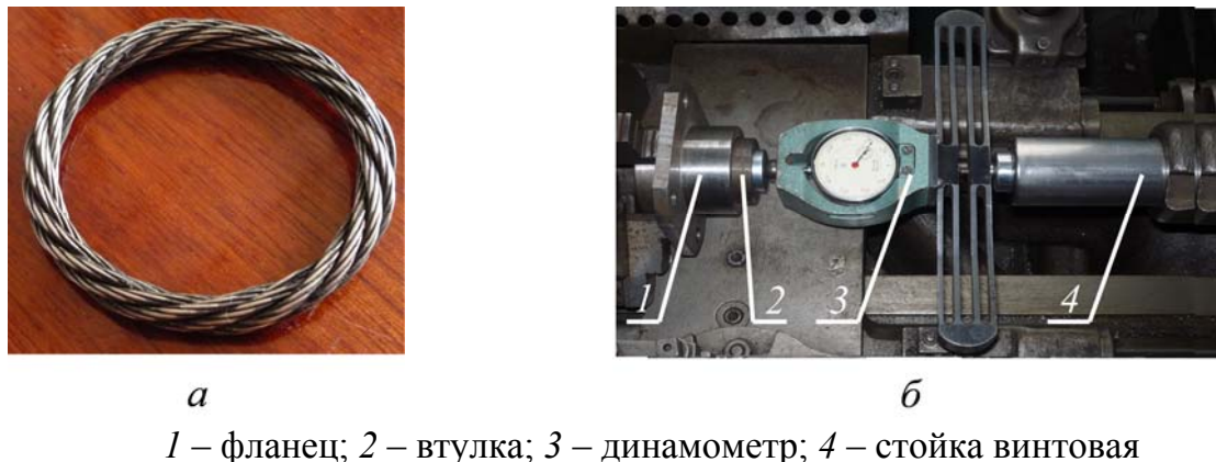
Рисунок 9 – Внешний вид ККВ ( а ), установка для проведения статических испытаний ККВ ( б )
