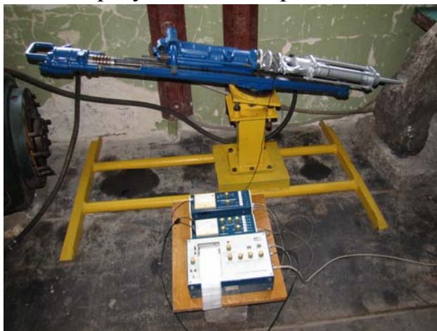
Рисунок 11 – Внешний вид испытательного стенда конструкции ДонГТУ с пневматическим отбойным молотком с ОС и ККВ
