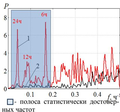
Рисунок 3 – Спектральная плотность ряда метановыделения при высоких (1) и низких (2) нагрузках
