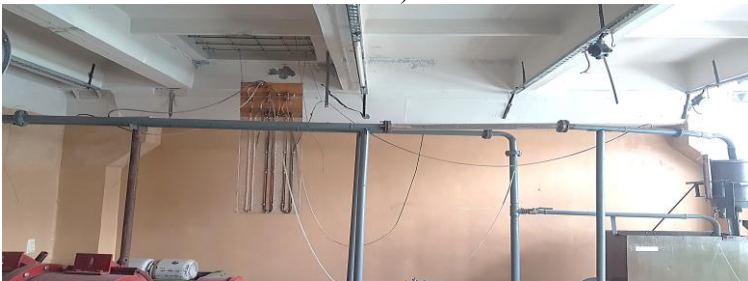
Рисунок 13 – Схема (а) и фото (б) экспериментального стенда для исследования характеристик течения ТВУС
