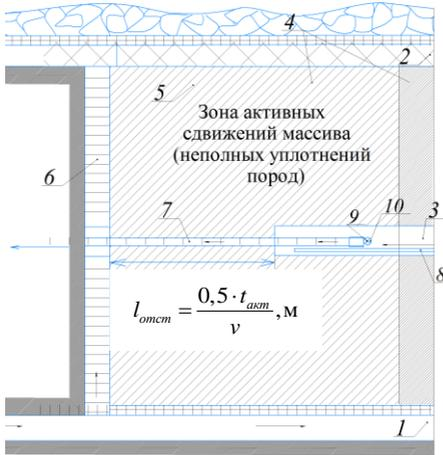
1, 2 – подготовительные выработки; 3 – промежуточный штрек в выработанном пространстве 4; 5 – зона неполных уплотнений пород; 6 – лава; 7 – трубопровод, обеспечивающий связь 3 и 6, 8 – трубопровод, по которому из проходческого забоя выработки 3 высасывается пыль и отработанный воздух; 9 – вентилятор местной проветривания, нагнетающий в лаву 6 воздух, охлажденный устройством 10
