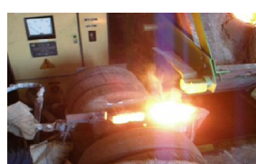
Подключение тока к ковшу-реактору
