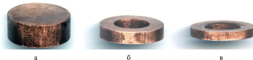
Рисунок 1 Образцы для анализа равноплотности: а — донная, б — кольцевая, в — торцевая части
