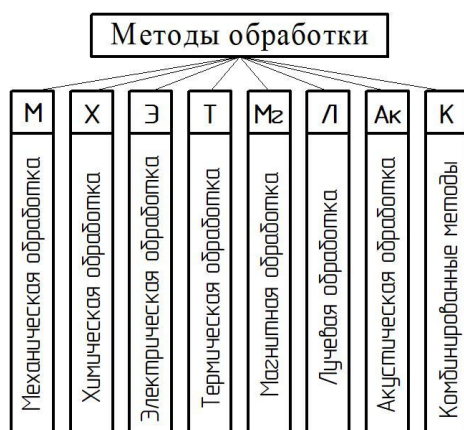
Рисунок 1 — Классификация методов обработки по виду затрачиваемой энергии
