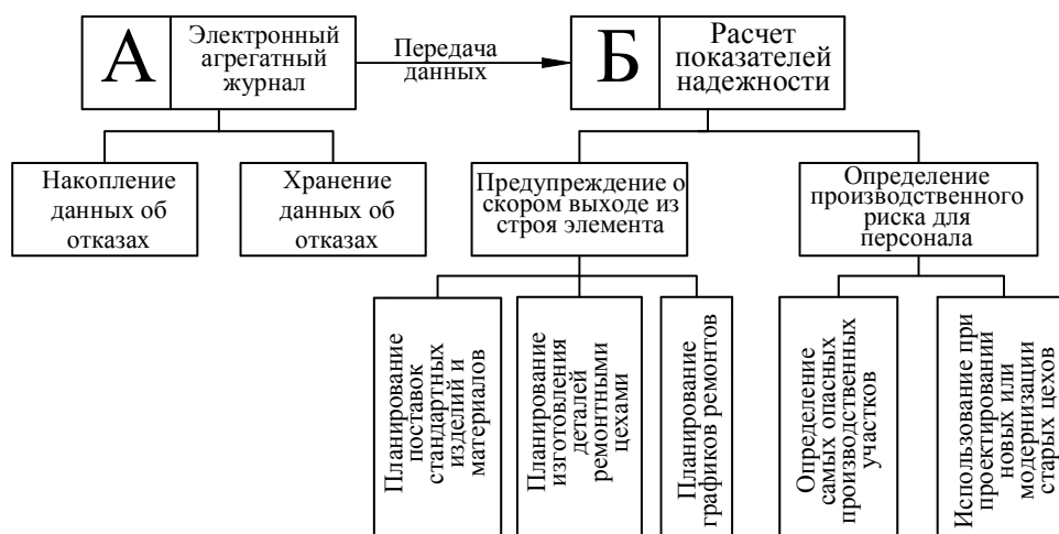
Рисунок 1 — Схема описания системы прогнозирования отказа оборудования
