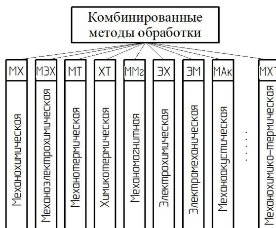
Рисунок 2 — Классификация комбинированных методов обработки по виду применяемой энергии
