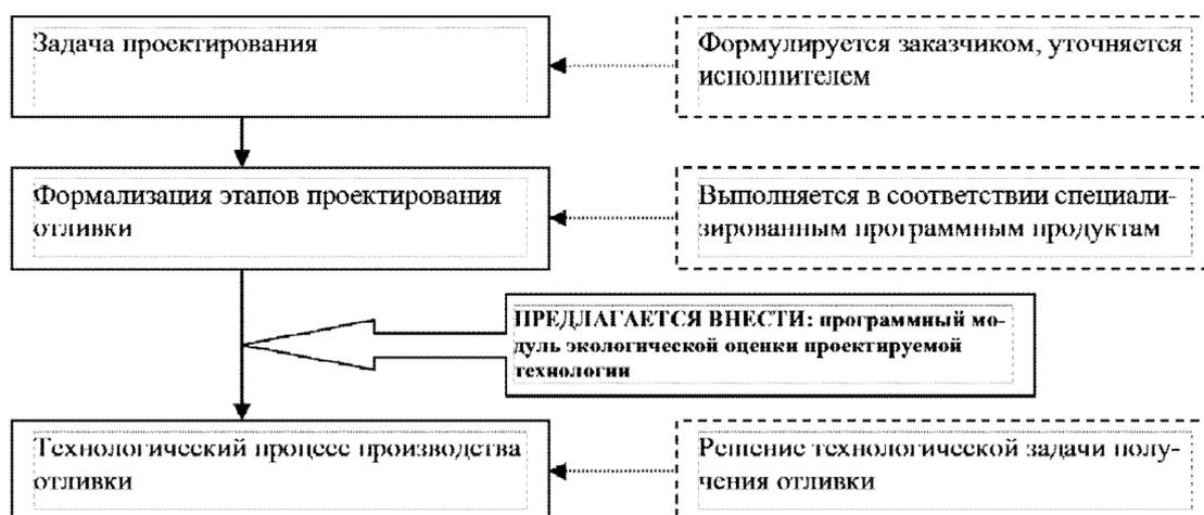
Рисунок 1 — Укрупненный алгоритм разработки процесса проектирования технологии изготовления отливки
