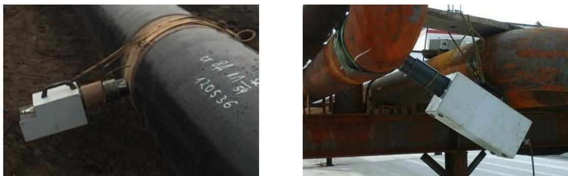
Рисунок 1 — Примеры установки рентгеновского аппарата для проведения контроля сварных соединений
