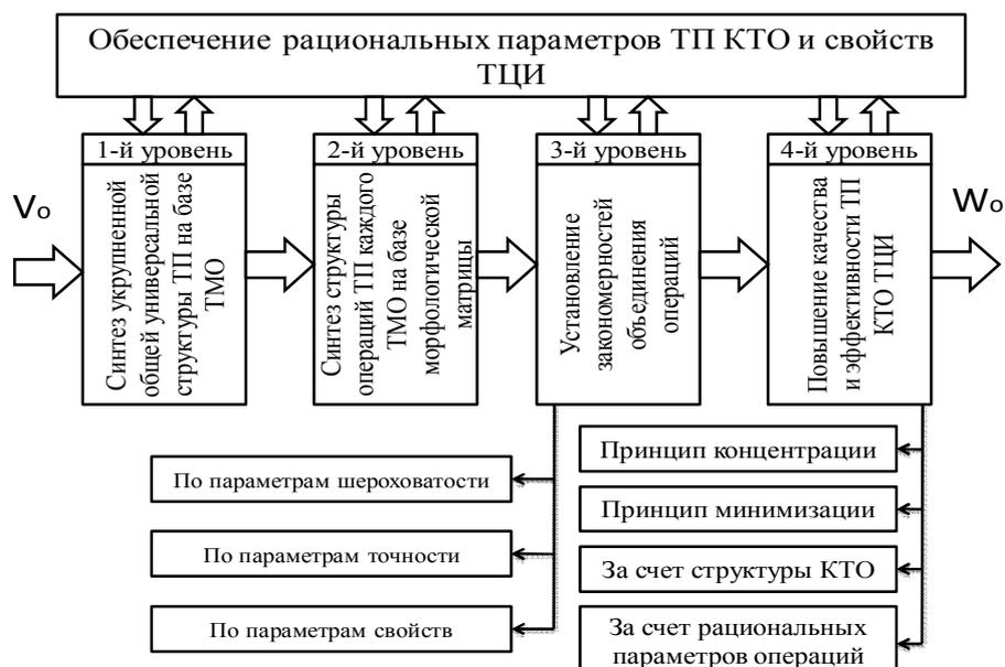
Рисунок 1 — Структурная схема общего подхода проектирования технологического процесса комбинированной технологии обработки тонкостенных цилиндрических изделий
