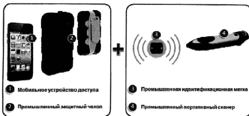
Рисунок 1 — Состав мобильного комплекса
