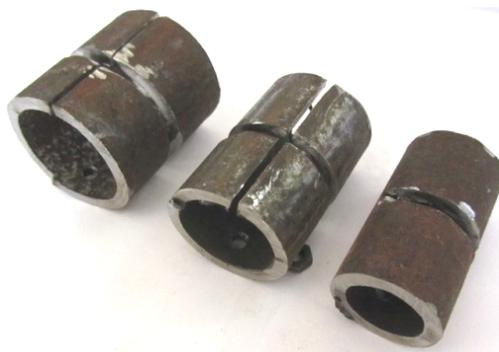
Рисунок 2 — Сменный комплект разрезных втулок для фиксации труб различного диаметра на несущей рамке режущего блока
