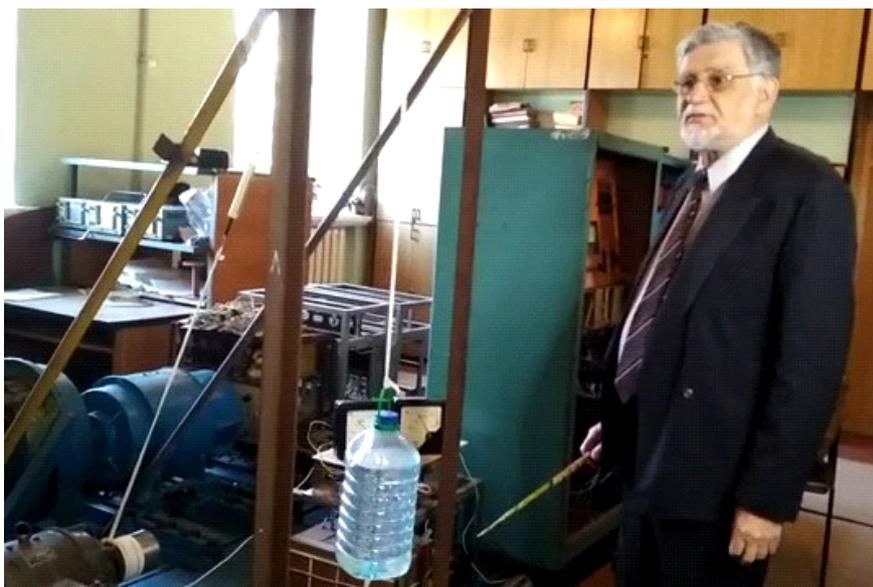
Рисунок 1 — Физическая модель механизма подъёма крана с ЭП, который имеет ММХ
